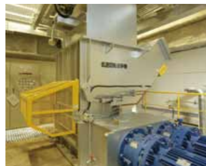
低速回転破砕機 ゆっくりと回転する刃でごみをだまかに破砕し、その後の処理をスムーズにします。
