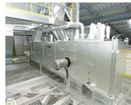
アルミ選別機 回収した可燃物からアルミを選別します。
