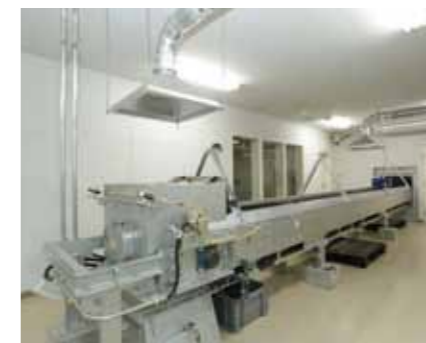
手選別室 手作業により異物や処理不適物を取り除きます。
