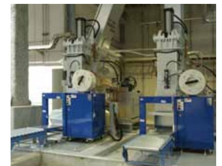
ペットボトル圧縮梱包機 回収されたペットボトルを圧縮し梱包します。
