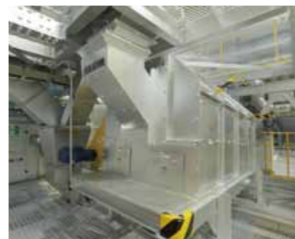
粒度選別機 破碎ごみを穴の大きさが異なる円筒の回転式ふるいにかけて、粒度差によって不燃物・可燃物に分別します。
